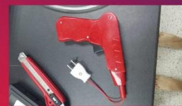
圖五. 改裝電子點火槍作為電源；其優點是使用電池即可運作。
