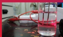
圖四. 改裝傳統火花打點器作為電源；相較於電子點火槍的優點是電能較高；微粒產生較快
